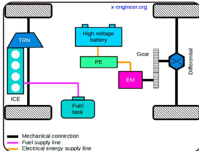
يتطلب هذا الحل ناقل حركة أوتوماتيكي على المحور الأمامي ، مما يجعل من الممكن فصل المحرك أثناء قيادة السيارة الكهربائية. وتمثل ميزة هذا الحل في أن السيارة مزودة بنظام الدفع الرباعي طالما أن البطارية غير مستنفدة.
