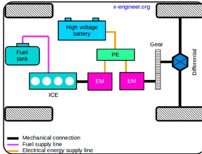
أيضاً ، لا يوجد قابض بين المحرك الكهربائي وعجلات القيادة. هذه ميزة من حيث التغليف ولكنها لا تسمح للركبة بالركوب لأن المحرك الكهربائي سيكون دائماً متصلاً بعجلات القيادة.
